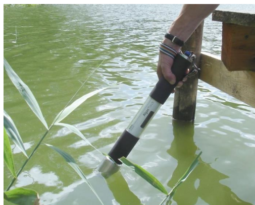
Thiết bị cho số liệu định lượng tảo ngay lập tức tại hiện trường (ao nuôi, ao lắng, môi trường xung quanh,...)
